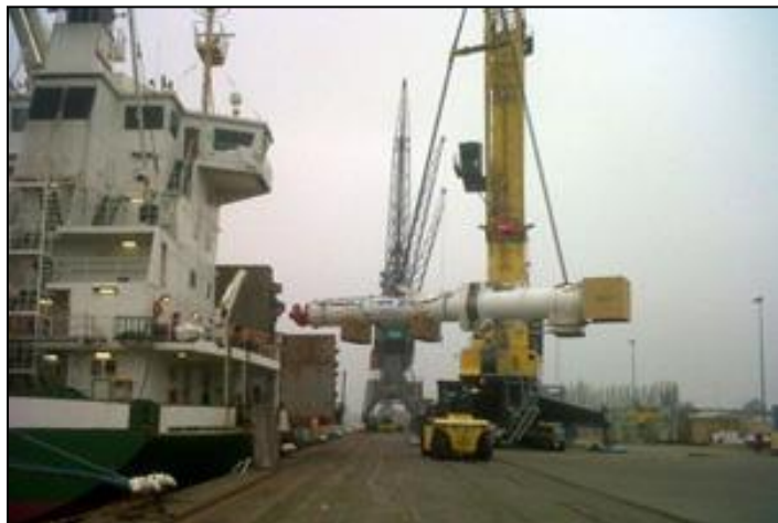
Porto di Ravenna – Testa di scavo (parte centrale), coclea e main drive della TBM
