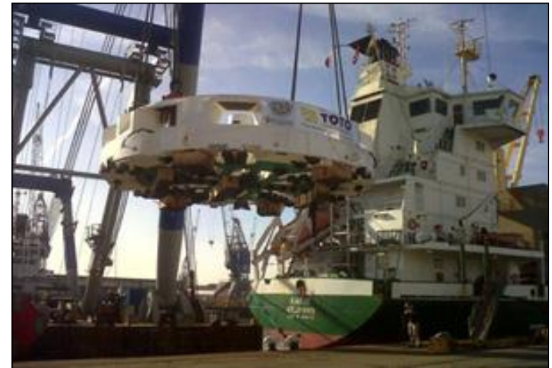
Porto di Ravenna – Testa di scavo (parte centrale), coclea e main drive della TBM
